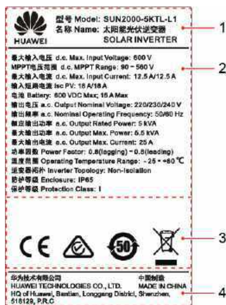
Рисунок 2-6. Заводская табличка (на примере SUN2000-5KTL-L1)
